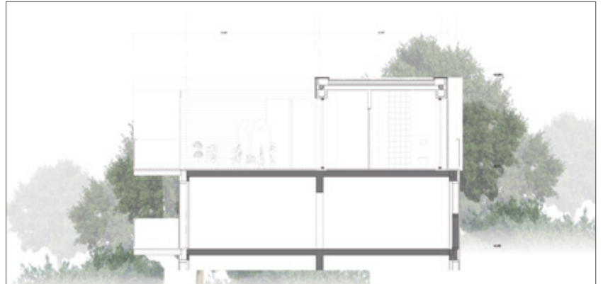
Querschnitt: Dachaufstockung auf Gebäudebestand
