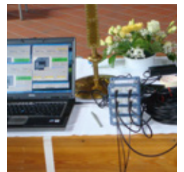
Messaufbau mit PC, A/D-Wandlern und Verkabelung
