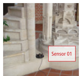
Sensor 01 auf dem Sockel des Sakramentenhauses (triaxial)
